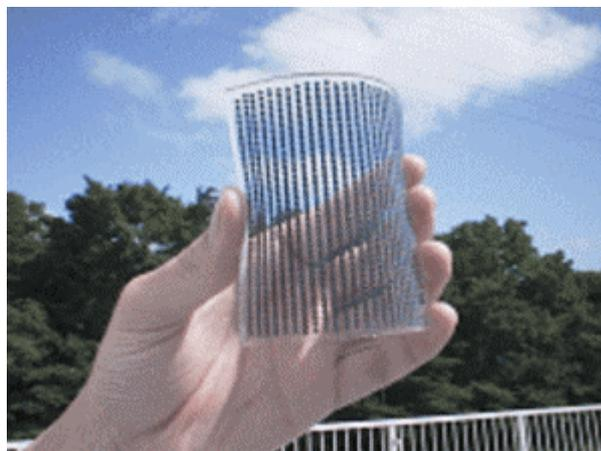
Fig.2.: celle fotovoltaica flessibile.
